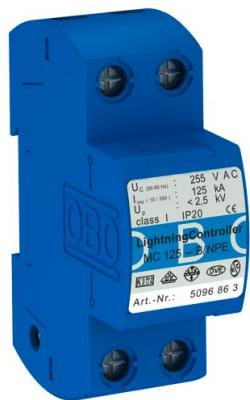
用于 TN-S 和 TT 系统, 作为 N-PE 间的火花间隙保护器, 满足 IEC 61643 对 Type 1 (B 类) 保护器的要求, 适用于根据 IEC 61312-1 或 DIN VDE 0185-305 第 4 部分的防雷分区概念的 0 区到 1 区 (LPZ) 的 N 和 PE 之间的火花间隙。
